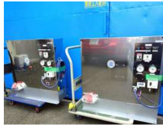
← ミラクルボーイ SRC-813-10V型 エレメント目詰り時と、過負荷異常停止時に、電気信号が出力される仕様です
