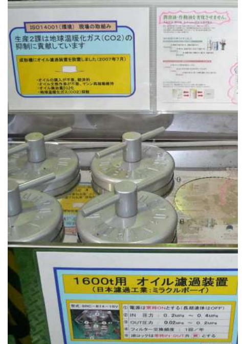
↑ 東芝機械殿の射出成形機に接続された ミラクルボーイ SRC-812-6V & SRC-814-15V
